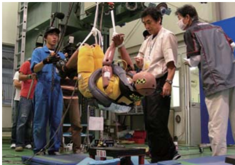
▶ 人体ダミーを使った実験風景。前方・後方・地面着地時の衝撃度合など、様々な実験を繰り返します。
